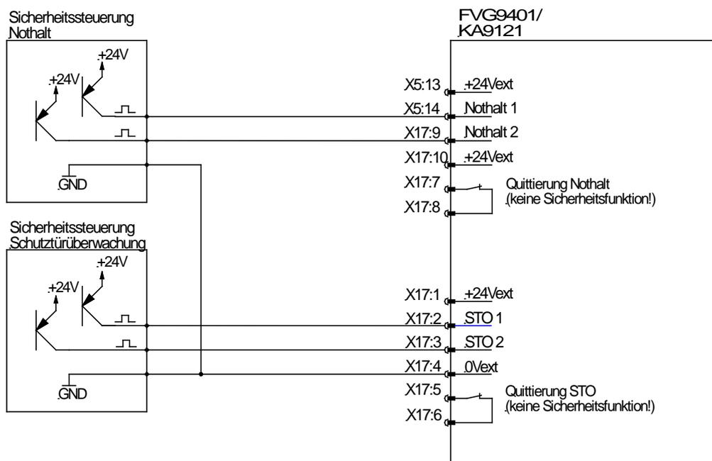
**Achtung:** Die Belegung von X17 ist gegenüber den alten Geräten geändert. Bei nicht vorhandener Option SLS darf X15 nicht beschaltet werden.
