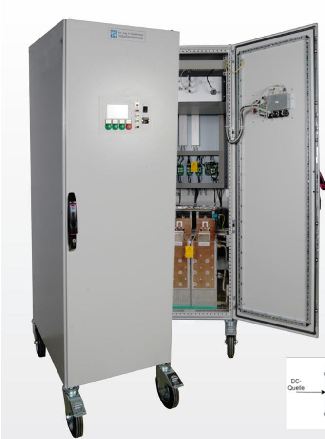
Die LISN500 (Line Impedance Stabilization Network) ist ein Netzwerk zur Nachbildung der DC-Bordnetzimpedanz, um Messungen an Komponenten mit Hochvolt-Gleichstromversorgung auf Prüfständen unter reproduzierbaren Bedingungen durchzuführen. Die LISN500 erfüllt die Anforderungen der Normen für elektrisch angetriebene Straßenfahrzeuge ISO21498, MBN11123 und vergleichbare.
